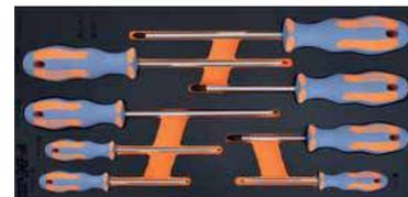
**Assortimento di 8 giraviti in alloggiamento da 1/3**
