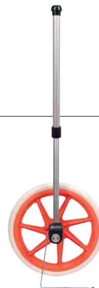
Ruota  $\varnothing$  318,5 mm (1 giro = 1 m), rivestita in gomma per terreni accidentati e disagiati
