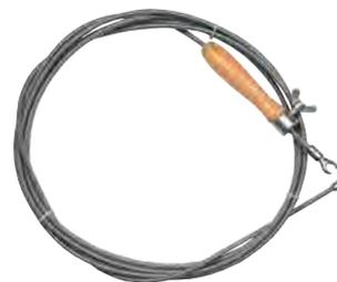
**Con impugnatura a manovella e testina intercambiabile con spirale conica rovesciata**
